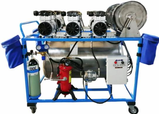
Дыхательные системы Air line - это системы, которые носят на спине и талии и обеспечивают пригодный для дыхания чистый воздух, необходимый персоналу для работы в помещениях, слишком узких, чтобы в них можно было входить с респираторными устройствами. Система комбинируется с системой шлангов и катушек, которые в стандартной комплектации могут быть удлинены до 33 метров в загрязненных или с дефицитом кислорода средах.
