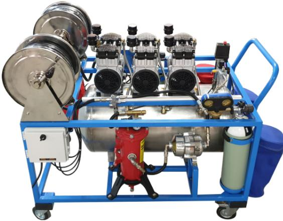
2 hp 220 v (или 380 v) электрический компрессор обеспечивает 7 бара сжатого воздуха, также имеет 150лт. плоский резервуар, 2 шт. 50-метрового шланга и бобин для шланга, 2 клапана и 2 полнолицевой маски, 6 лт - 300 бар запасная воздушная трубка которая обеспечивает автоматический воздух в случае отключения электроэнергии, воздушный регулятор и аварийный манифольд, 2 шт. алюминиевый корпус фильтра, регулятор для воздуха в баке.
